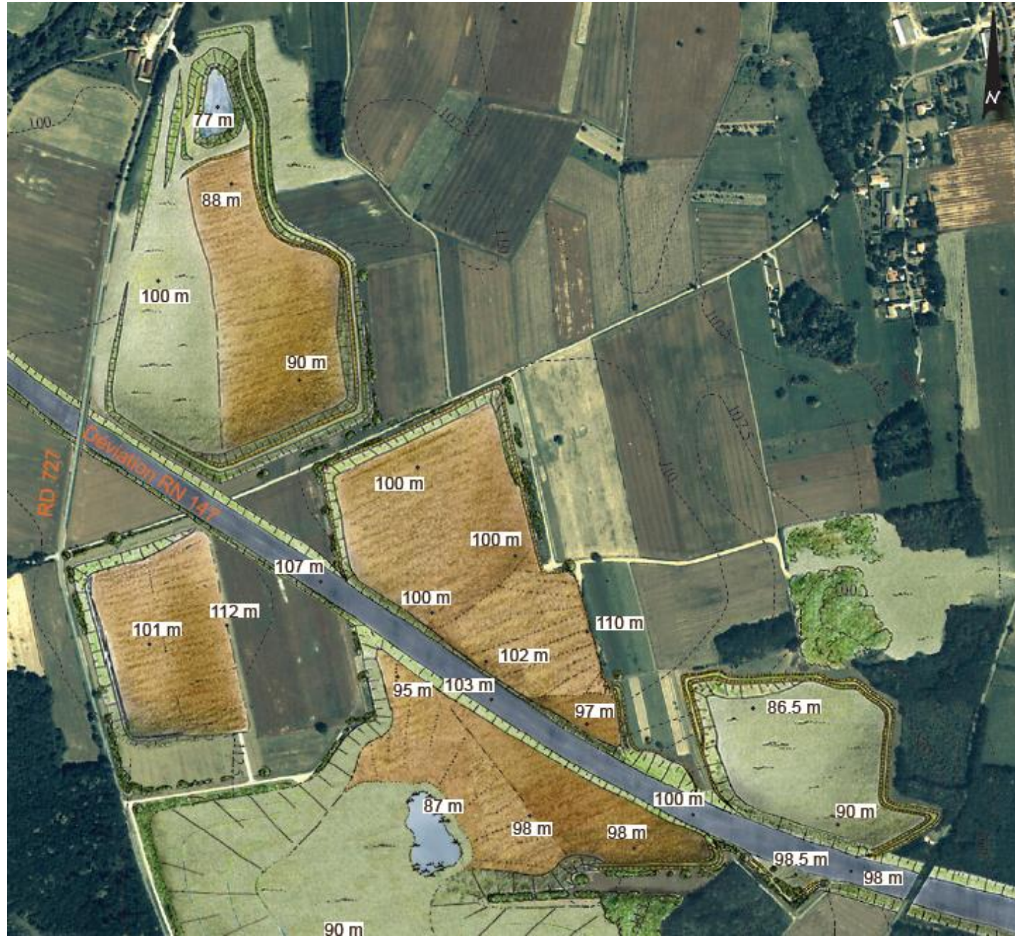
Plan de remise en état final avec la déviation de la RN 147 - Principes généraux (ETUDE PAYSAGERE Complémentaire, ENCEM Montpellier 2011). Les côtes indiquées sont indicatives et ont vocation à être actualisées.
